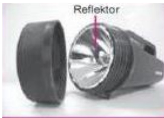
Gambar 2.8 Reflektor pada Senter
