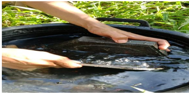
Gambar 4.5 Pelepasan Paving Block dari cetakan
