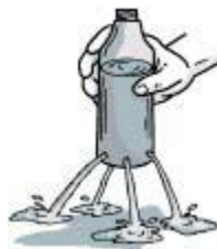
Gambar 2.4 Tekanan air menyebabkan air Memancat keluar
