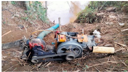
Gambar 3. Mesin Diesel/Mesin Dompeng
