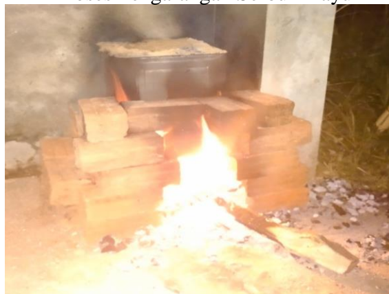
Gambar 4.6 Proses Pengarangan Serbuk Kayu
