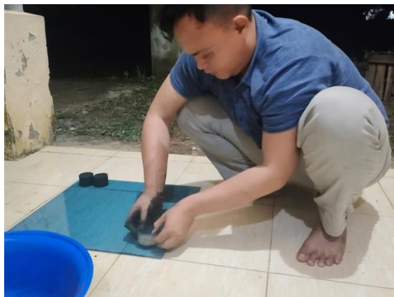
Gambar 4.12 Peneliti melakukan percetakan briket
