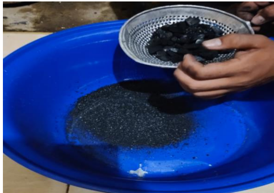
Gambar 4.7 Proses Penghalusan Arang Serbuk Kayu
