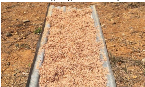
Gambar 4.2 Proses Pengeringan Serbuk Kayu
