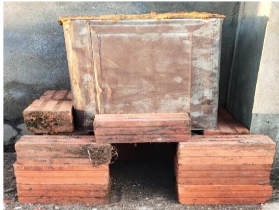
Gambar 4.5 Persiapan Pengarangan Serbuk Kayu
